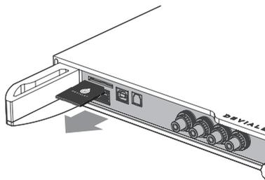
2 - 弊社サイト([www.devialet.com](http://www.devialet.com))からアップロードファイルをダウンロードしてSDカードに転送したら、本機器のSDカードスロットに再び挿入してください(ライトプロテクトは解除しておきます)。
