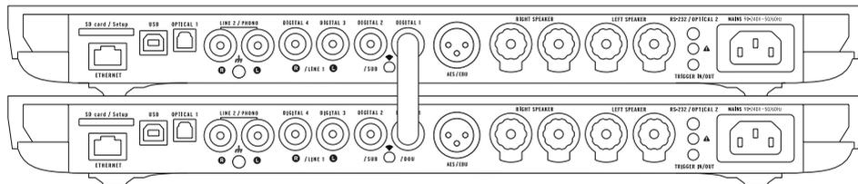
ご利用のシステムをデュアル-モノモードの構成にするためには、スピーカーをそれぞれデビアレに接続し、二台のデビアレをデジタルケーブル（S/PDIFまたはS/PDIF-AES/EBU）で接続します。コンパニオンデバイスの入力を使いたい場合には、ステレオミニジャックアナログケーブルで二台のデビアレを接続します。
