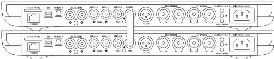
Pour configurer votre système en mode dual-mono, branchez chaque enceinte sur un appareil et reliez les par un câble digital (S/PDIF ou S/PDIF-AES/EBU). Si vous souhaitez utiliser les entrées de votre appareil Companion, reliez également les deux appareils grâce à un câble analogique stéréo mini-jack depuis le connecteur trigger in/out du Master vers le connecteur RS232 du companion.
