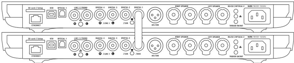
Zum Einstellen Ihrer Anlage auf Dual-Monobetrieb schließen Sie jeden Lautsprecher an ein Gerät an, und verbinden Sie beide Geräte über ein Digitalkabel (S/PDIF oder S/PDIF-AES/EBU). Wenn Sie die Geräteeingänge des Companion nutzen möchten, verbinden Sie beide Geräte über ein analoges Kabel mit Stereo-Miniklinkenstecker miteinander.
