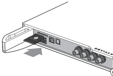
4 - 插入 SD 卡之后，新配置将由您的音响系统自动读取。无需重启设备。把 SD 卡留在主机内。
