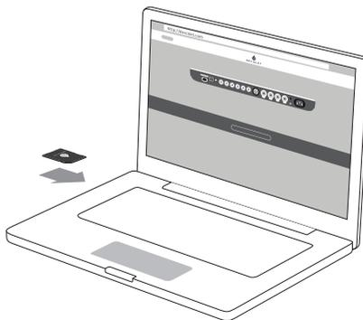
3 - Cuando haya transferido la configuración a la tarjeta SD, vuelva a insertarla en el lector del Expert.
