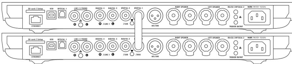
要将您的系统设置为双单声道模式，请将每台机器分别与一个扬声器连接，同时将两台机器使用数码线缆连接 (S/PDIF or S/PDIF-AES/EBU)。如需使用辅机的输入功能，请使用小号音频信号数据线将辅机与主机连接。
