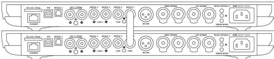
Per configurare il vostro sistema in modalità dual-mono, collegate ogni altoparlante a un Expert, quindi collegate gli apparecchi tramite cavo digitale (S/PDIF o S/PDIF-AES/EBU).
