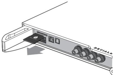
2 - 将SD卡插入您的电脑，登录 [www.devialet.com](http://www.devialet.com), 进入配置器页面，并根据提示进行设置。
