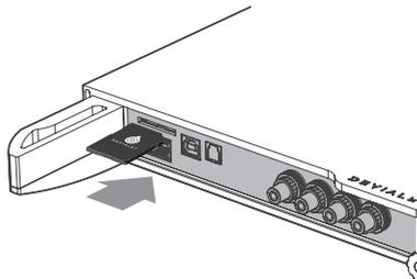
4 - La nouvelle configuration est automatiquement lue par votre Expert dès l'insertion de la carte SD. Il n'est pas nécessaire de redémarrer l'appareil.
