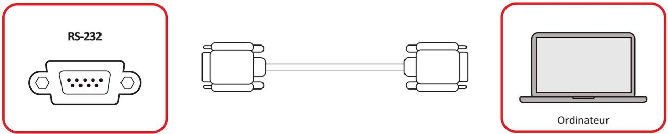
Lorsque vous utilisez un câble de port série RS-232 pour connecter votre écran à un ordinateur externe, certaines fonctions peuvent être contrôlées à distance par le PC, y compris la mise sous tension/hors tension, le réglage du volume, la sélection de l'entrée, la luminosité, etc.
