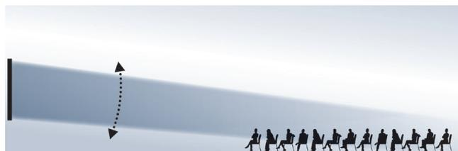
Die vertikale Abstrahlcharakteristik der DSP-gesteuerten Line-Arrays ist mit unserer neuen **LB AUDIO CONTROL Software** einstellbar.
