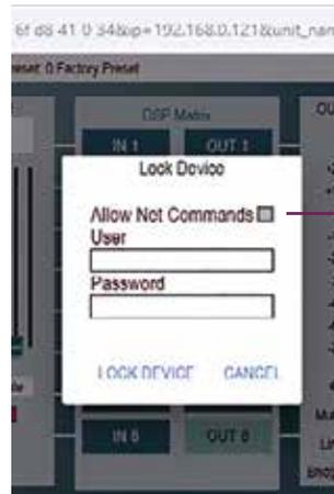
Beim Verriegeln eines Gerätes (Lock) werden neben der Bedienung über die App auch Netzwerkbefehle zur Einstellung des Gerätes blockiert.
