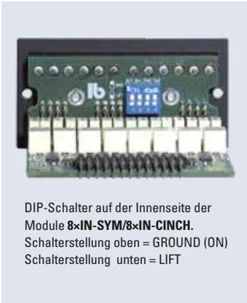
DIP-Schalter auf der Innenseite der Module 8xIN-SYM/8xIN-CINCH. Schalterstellung oben = GROUND (ON) Schalterstellung unten = LIFT
