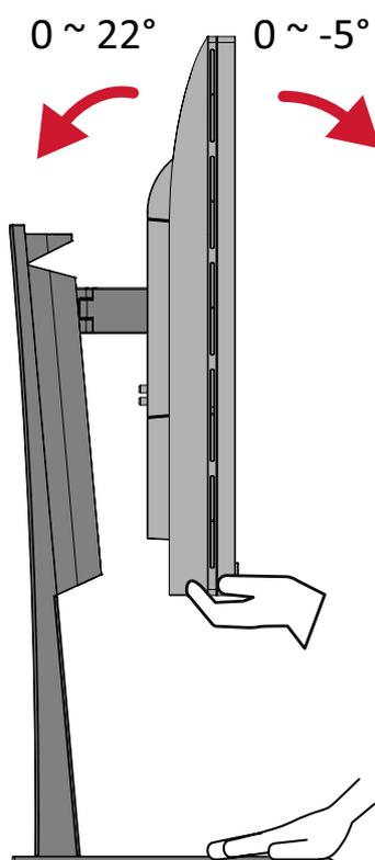
**REMARQUE :** Lors du réglage, tenez fermement le support avec une main tout en inclinant le moniteur vers l'avant ou l'arrière avec l'autre main.
