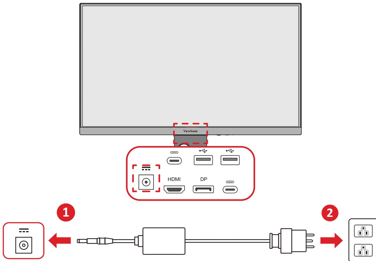
1. Branchez l'adaptateur d'alimentation sur la prise ENTRÉE CC située à l'arrière de l'appareil.
