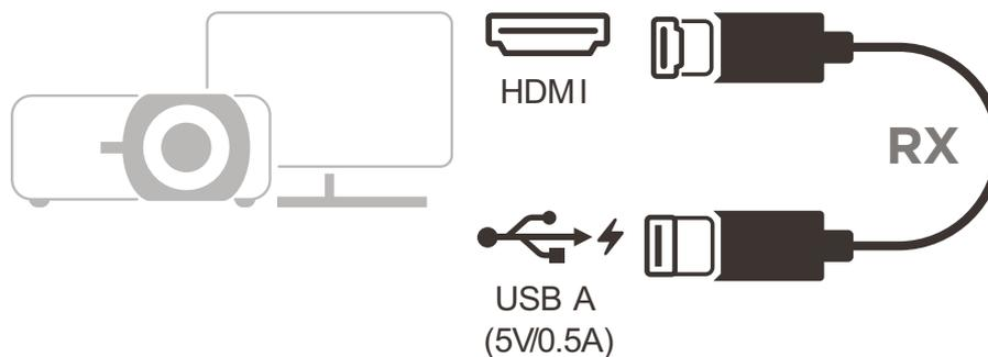
1. Verbinden Sie den HDMI-Ausgang des Empfängers mit einem **HDMI**-Anschluss des Projektors.
