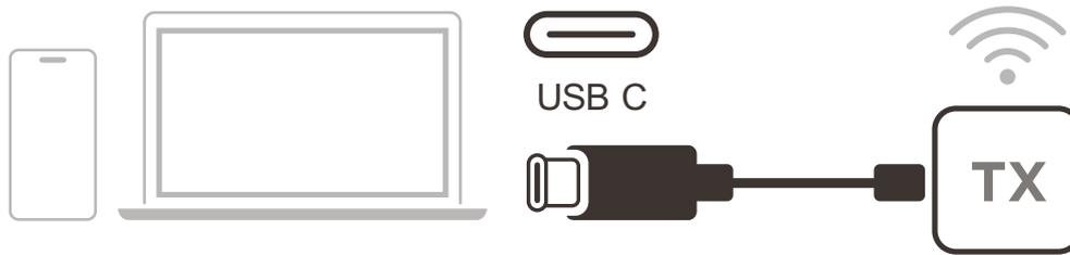
1. Verbinden Sie den USB-C-Eingang des Senders mit einem **USB-C**-Anschluss des Übertragungsgerätes (z. B. Laptop, Mobiltelefon, Tablet).
