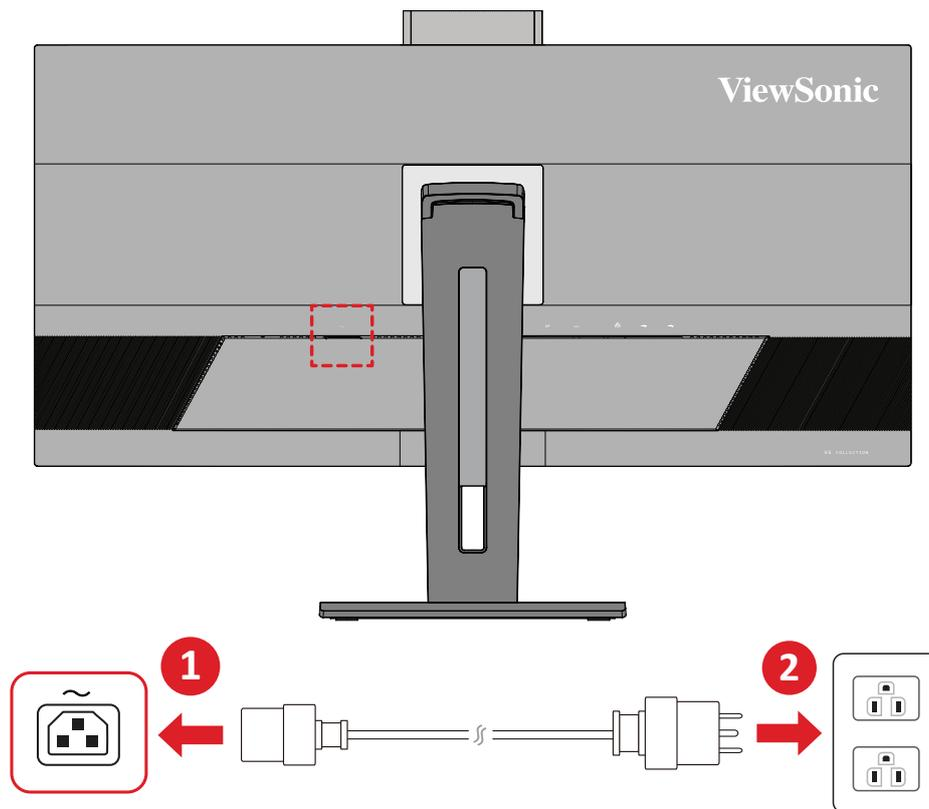
1. Connectez le cordon d'alimentation sur la prise AC IN située à l'arrière de l'appareil.
