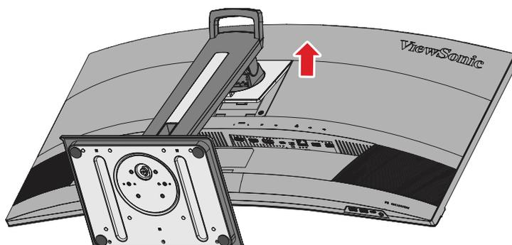
4. Baissez légèrement pour dégager les crochets et retirer le support.
