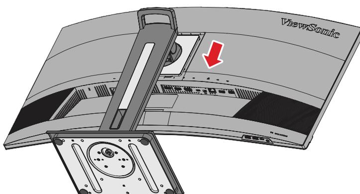
5. Fixez le support de montage aux trous de montage VESA au dos de l'appareil. Puis fixez-le avec quatre (4) vis (M4 x 10 mm).
