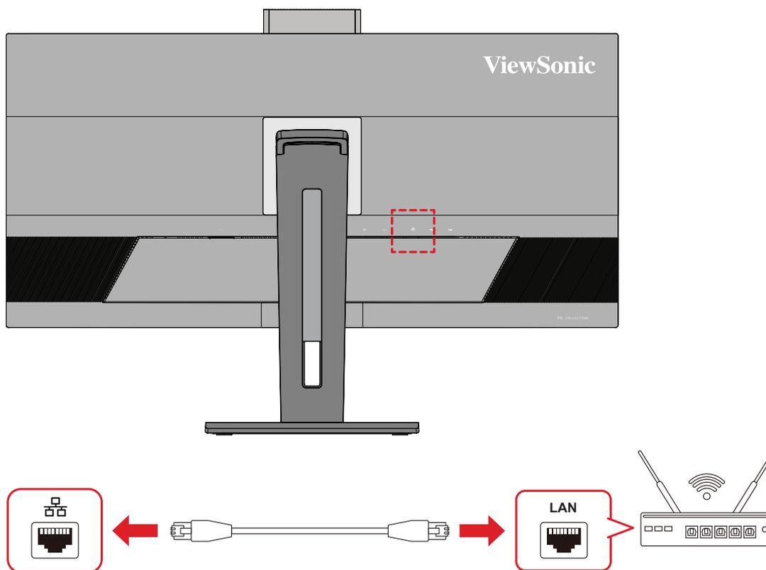
1. Connectez une extrémité de votre câble LAN (RJ45) au port LAN (RJ45) du moniteur.
