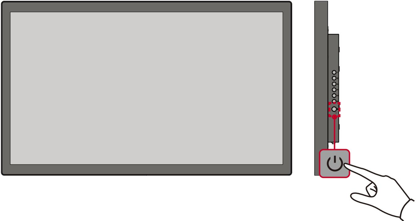
**Hinweis:** Der Monitor verbraucht weiterhin Strom, solange das Netzkabel an die Steckdose angeschlossen ist. Bitte ziehen Sie den Netzstecker aus der Steckdose, wenn der Monitor längere Zeit nicht benutzt wird.
